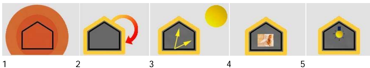
Obrázek 14: Domy vystavěnými tradičními stavebními technologiemi vytápíte své okolí. (1). Koncepce pasivního domu tento nešvar odstraňuje pomocí vynikající izolace a zpětným získáváním tepla z odpadního vzduchu a ohříváním přiváděného čerstvého vzduchu. (2), konsekventním využíváním sluneční energie (3), užíváním odpadních vod obyvatel (4) a vnitřních zisků (5) 15
