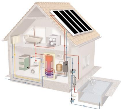
Obrázek28: Solarární zařízení s připojeným systémem vytápění a plaveckým bazénem 27
