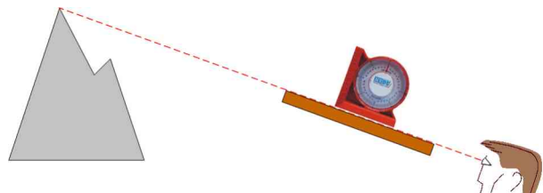
Obrázek 8: Určování elevace (ATB-Becker)
