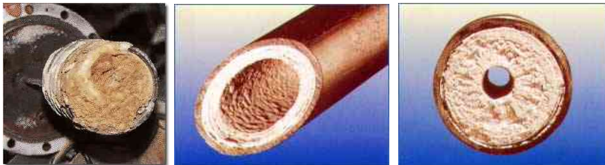
Obr.4.22: Vápenné usazeniny: vlevo na trubkovém žebrovém výměníku, vpravo v trubkách
