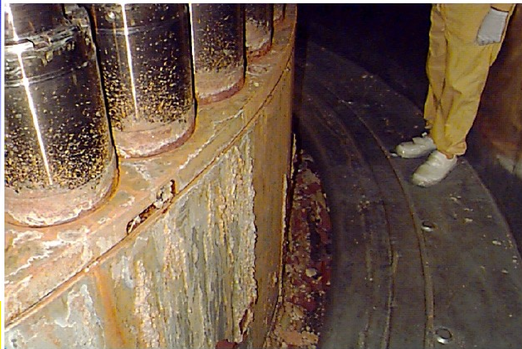
JETE - Detailní pohled na přírubu víka reaktorové nádoby se svorníky
